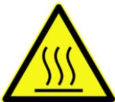
Dieses Symbol weist auf die heiße Oberfläche des Gerätes, während des Betriebes und danach hin. Verbrennungsgefahr bei Nichtbeachten!
